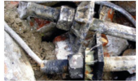
Widok prętów, które mocowały silnik spalinowy Diesel'a znajdujący się w elektrowni, pogieęte przez wybuch i odsłonięte podczas wykopów.
